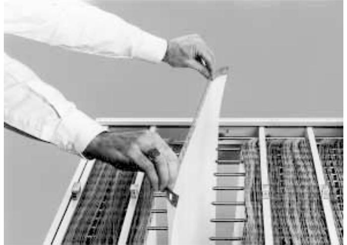
Le dessin désiré peut être sorti. Pour fermer le mécanisme pressez l'un contre l'autre des boutons noirs de l'élément de manègement et repoussez dans la position de base.
